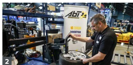
Der halbautomatische Wulstabdrucker spart Kraft.
